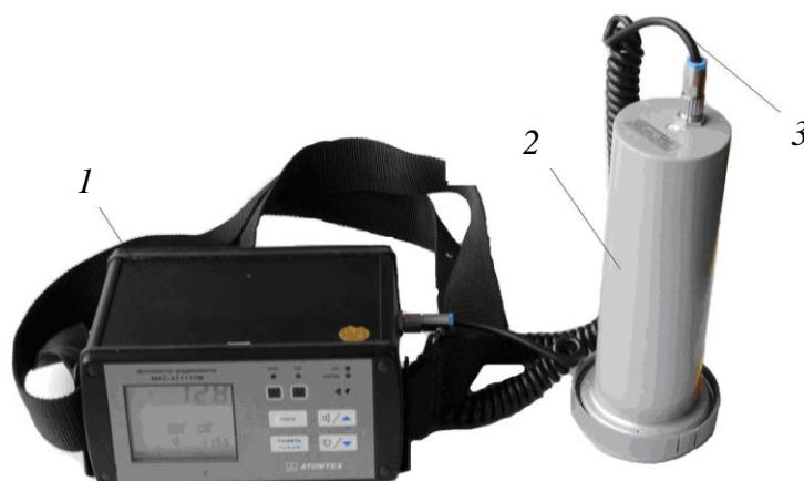
Рис. 14.2. Дозиметр-радиометр МКС-АТ1117М: 1 – блок обработки информации (БОИ); 2 – блок детектирования БДПБ-01; 3 – соединительный кабель
