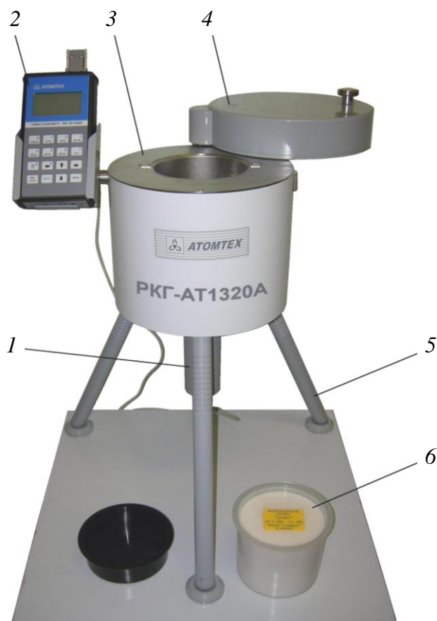
Рис. 13.2. Общий вид гамма-радиометра РКГ-АТ1320А:
