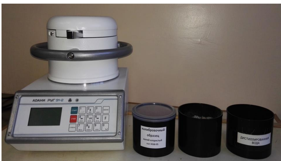
Рис. 12.1. Общий вид гамма-радиометра РУГ-91-2
