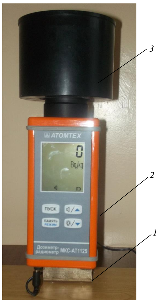
Рис. 16.2. Общий вид дозиметра-радиометра МКС-АТ1125 на подставке:
