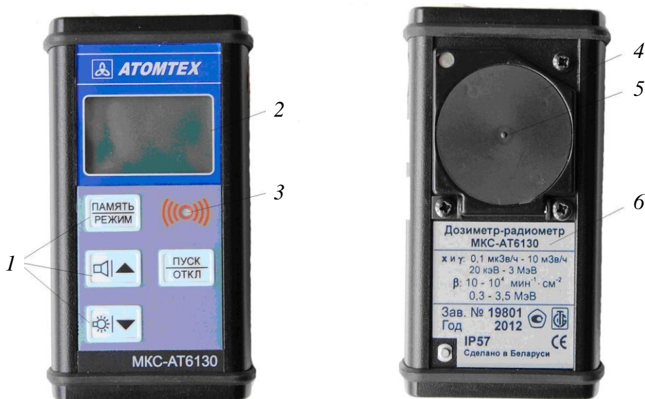
Общий вид дозиметра-радиометра МКС-АТ6130:
